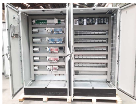
SUMINISTRO Y CABLEADO DE DCS Y PLC MULTIMARCA
